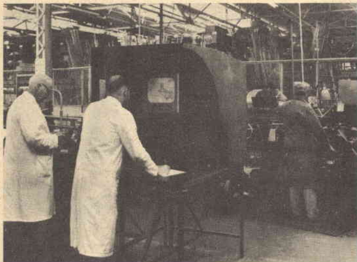
Uno dei posti di operazione esterni. L'operatore sta esaminando un particolare del disegno che ha ingrandito azionando a distanza l'obiettivo zoom.
