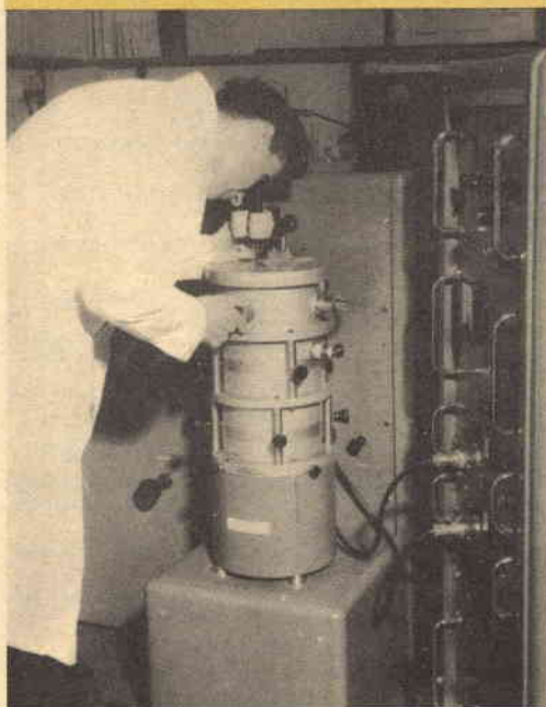
Fig. 2 - Nella foto è visibile la macchina utensile a fascio elettronico usata presso il Royal Radar Establishment (Malvern, Gran Bretagna).
